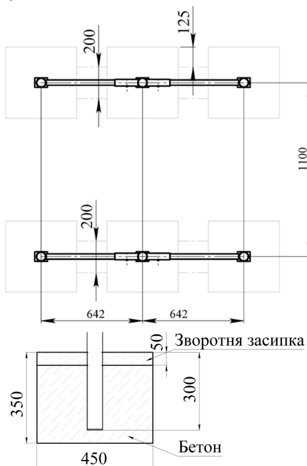
Рис. 3 Схема монтажу фундаментів
